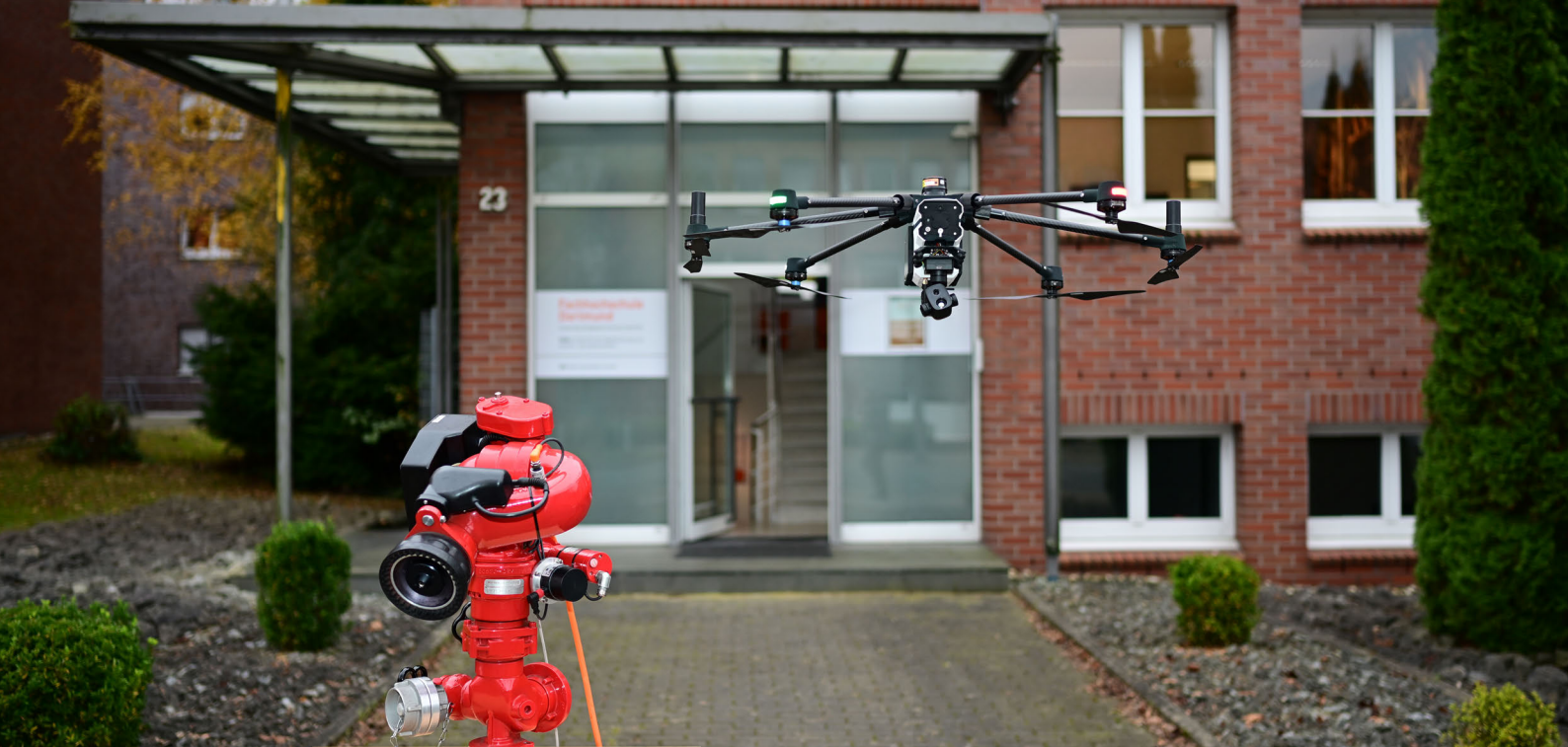
▲ Abb. 1: Testaufbau des Löschedemonstrators mit Hexacopter Fig. 1: Test setup of the extinguishing demonstrator with hexacopter
